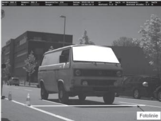
Abbildung 11: VW T3-Bus mit Seitenabstand von 5,3m im Datenfeld und ermittelten Seitenabstand von 3,2 m (Abweichung =2,1 m)
