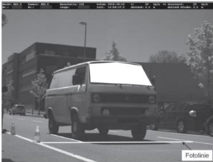
Abbildung 10: VW T3-Bus mit Seitenabstand von 3,6m im Datenfeld und ermittelten Seitenabstand von 3,1 m (Abweichung =0,5 m)
