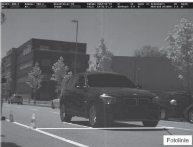
Abbildung 12: BMW X1 mit Seitenabstand von 5,0m im Datenfeld und ermittelten Seitenabstand von 3,6 m (Abweichung =1,4 m)
