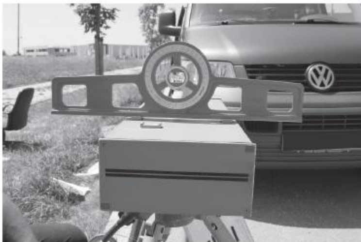
Abbildung 6: ES 3.0 mit Neigungswasserwaage (N:0°|R:0°) – hier Rollwinkel
